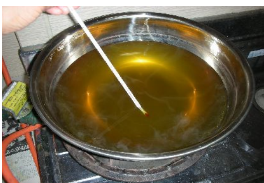
⑦一番液は60℃に暖めます。(染め布を入れると液の温度が下がりますので、70℃位に上げます。)
